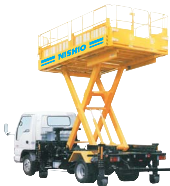
トンネル点検車
