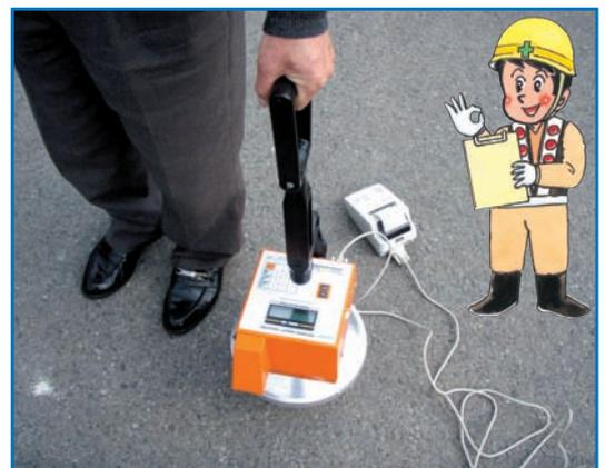
付属の専用ホルダーを取付けた状態です。測定時、かがむことなく計測できます。
