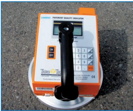
平たんな舗装面に置き、操作ボタンを押して、本体から手を離して測定します。
