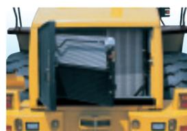
新たに波型パンチングメタルを採用し、空気中のゴミの侵入を防止。ラジエータコアをはじめエアコンコンデンサ、アフタクーラ用コアへも同位置からアクセス可能です。また、オプションでファンの風向きを逆転し、ラジエータに付着したゴミを吹き飛ばすオートリパーシングファンを用意しています。
