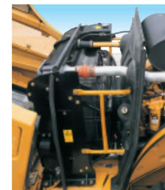
非金属隔壁によってエンジンコンパートメントから冷却システムを分離。車体後方より清浄な空気を導入できるリバースエアフローパターンを採用。また、ラジエータの大型化により冷却能力がアップされました。
