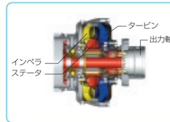
軽負荷・高回転域でトルクコンバータの抵抗を下げ、パワー伝達を効率よくアシスト。走行距離が長めの現場、ロード&キャリ工法などで、特に優れた省燃費効果を発揮します。
