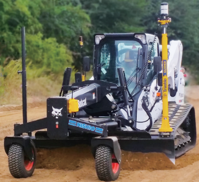
2D/3D制御によるマシンコントロールが可能。
