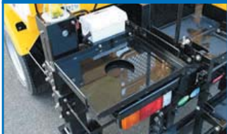
発電機設置スペース
