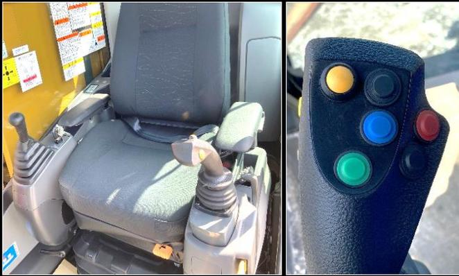
**電子制御ジョイスティックコントロール**
